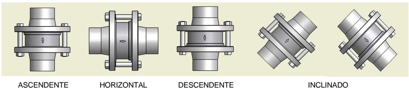
**ATENCIÓN:** en el caso de que se necesite instalar la válvula sin muelle, la misma sólo podrá colocarse en posición vertical (fluido ascendente).
