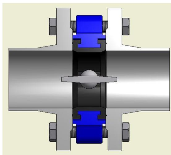
Abrir completamente la válvula antes de apretar los tornillos de las bridas.
