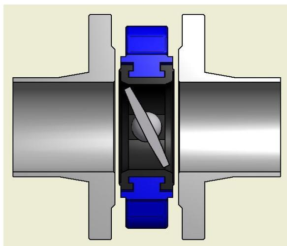
Dejar espacio suficiente entre bridas de modo que se pueda insertar o extraer la válvula fácilmente.
