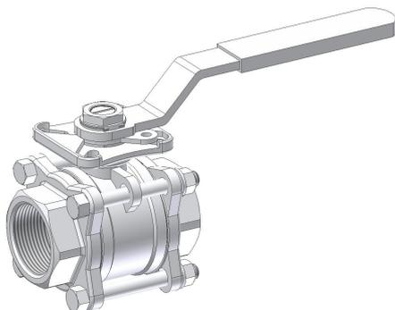
a.- Colocar la válvula en posición ABIERTA para impedir que la esfera sobresalga del cuerpo e interfiera con los extremos cuando se quita el cuerpo.
