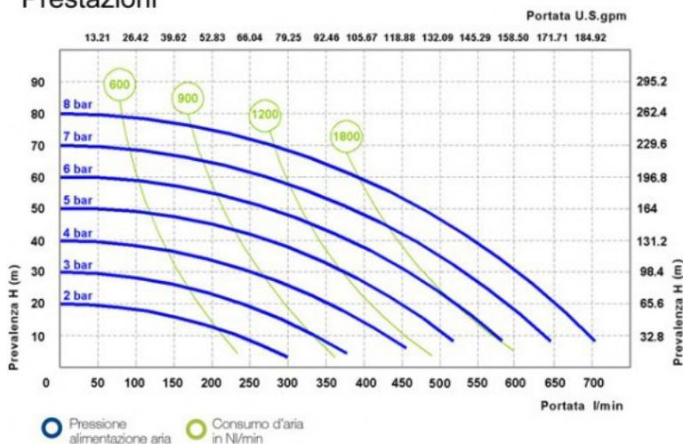
Le curve e le prestazioni sono riferite a pompe con aspirazione immersa e mandata a bocca libera, con acqua a 20° C, e variano a seconda del materiale di costruzione.
