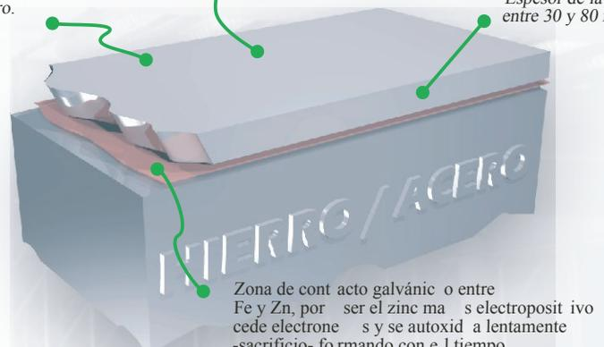
Zona de contacto galvánico entre Fe y Zn, por ser el zinc más electropositivo cede electrones y se oxida lentamente -sacrificio- formando con el tiempo carbonatos básicos y anulando virtualmente la oxidación del metal base.
