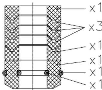
Colocar encima de la empaquetadura la arandela (part. 24) y posteriormente el muelle (part. 23). Enroscar todo este conjunto a la tapa o base del actuador (part. 12) y luego introducir por la parte superior el conjunto de eje con pistón.
