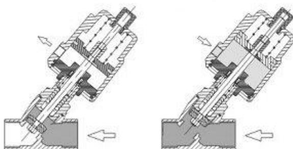
Actuador Simple Efecto (Retorno a resorte) Normal Cerrado (N.C.) / *Spring Return Actuator Normal Close (N.C.)*
