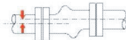
Desplazamiento Lateral / Lateral Displacement
